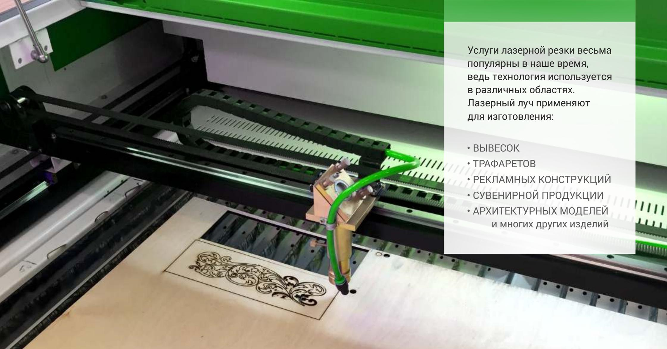
Услуги лазерной резки весьма популярны в наше время, ведь технология используется в различных областях. Лазерный луч применяют для изготовления:
